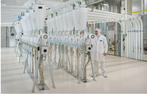
Proceso de tamizaje en el interior del molino.
